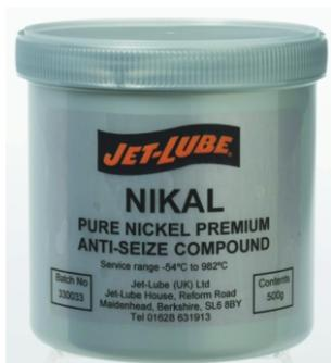
NIKAL è un composto di qualità superiore antigrippaggio e per tenute da utilizzarsi nel caso di temperature estreme ed in ambienti particolarmente gravosi. Il carrier di questo composto unico evapora progressivamente dopo esposizione a temperature estremamente alte e deposita una placatura metallica a base di nickel sulle connessioni filettate, evitando così il contatto metallo-metallo e proteggendo da grippaggio ed usura.
